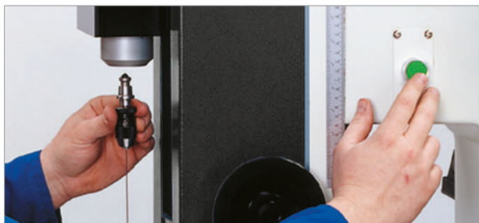
Opt. Ausstattung ZA-Baureihe: Pneumatisches Elektrodenwechselnsystem
