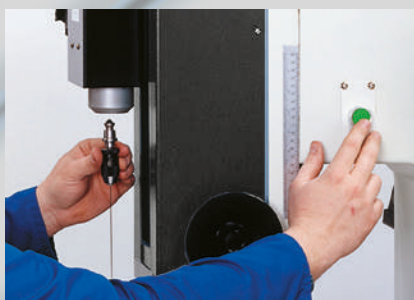
Opt. Ausstattung man. Maschinen: Pneum. Elektrodenschnellwechselsystem
