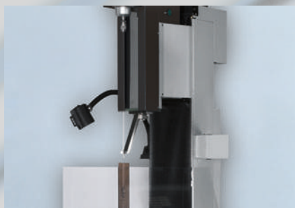
Kopferhöhung zur Bearbeitung hoher Werkstücke
